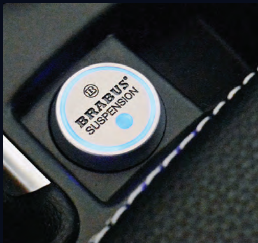
BRABUS Komfort Fahrwerk Ride Control auf Knopfdruck verstellbar (hart/weich)
